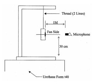
1 METER FROM MICROPHONE TO FAN INTAKE
